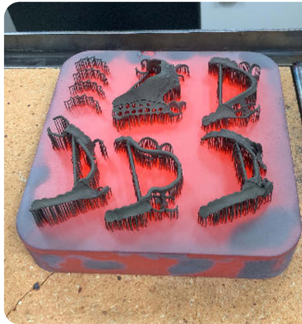
8. Schritt: Nach Abkühlung erfolgt das Nachfräsen
