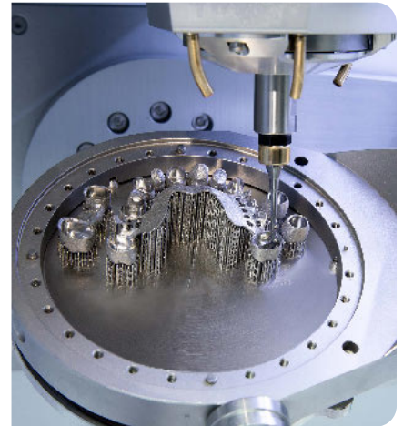
8. Schritt: Nach Abkühlung erfolgt das Nachfräsen
