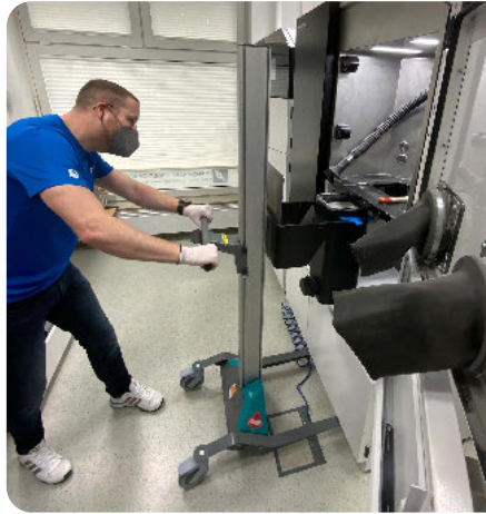
7. Schritt: Transport des Baumoduls vom Drucker zur Auspackeinheit CORITEC AM pure
