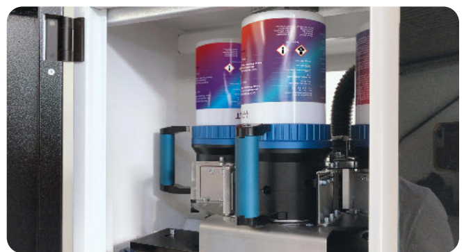
^ Integriertes Kartuschensystem für automatisierte und kontaktfreie Aufbereitung des überschüssigen Pulvers
