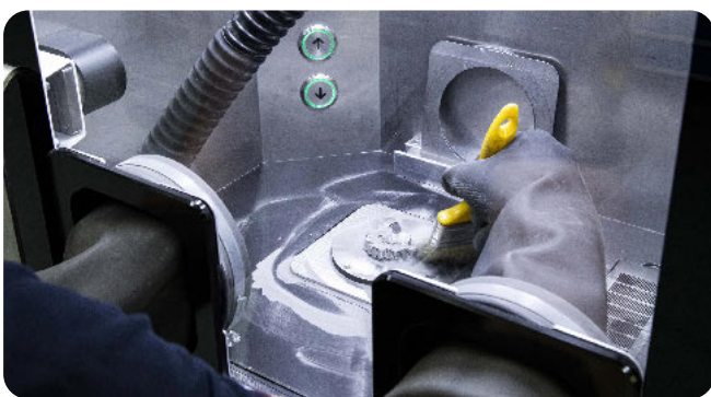
^ Säubern der gedruckten Teleskope nach dem Metalldruck
