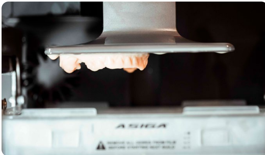
^ Mit zwei 3D-Druckern (Asiga Max und Elegoo Saturn) werden Intraoral-scans in Arbeitsmodelle verarbeitet.
